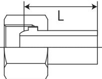
W29-16(R) ※ L:調整器継手端面からの寸法
