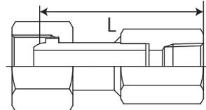
W29-16(R) ※ L:調整器継手端面からの寸法
