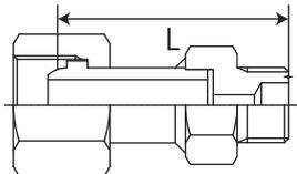
W29-16(R) ※ L:調整器継手端面からの寸法
