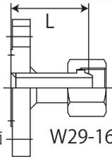
※ L:調整器継手端面からの寸法
