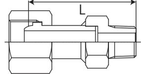
※ L:調整器継手端面からの寸法
